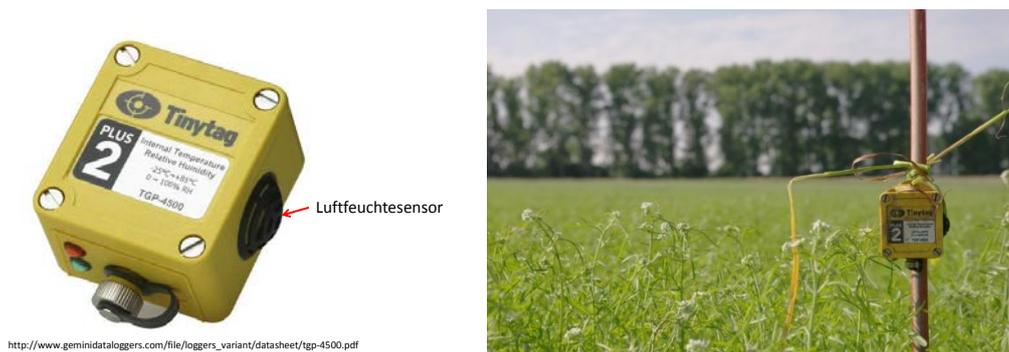
**Abb. 8:** Temperatur- und Luftfeuchtlogger von Tinytag und Positionierung im Bestand
