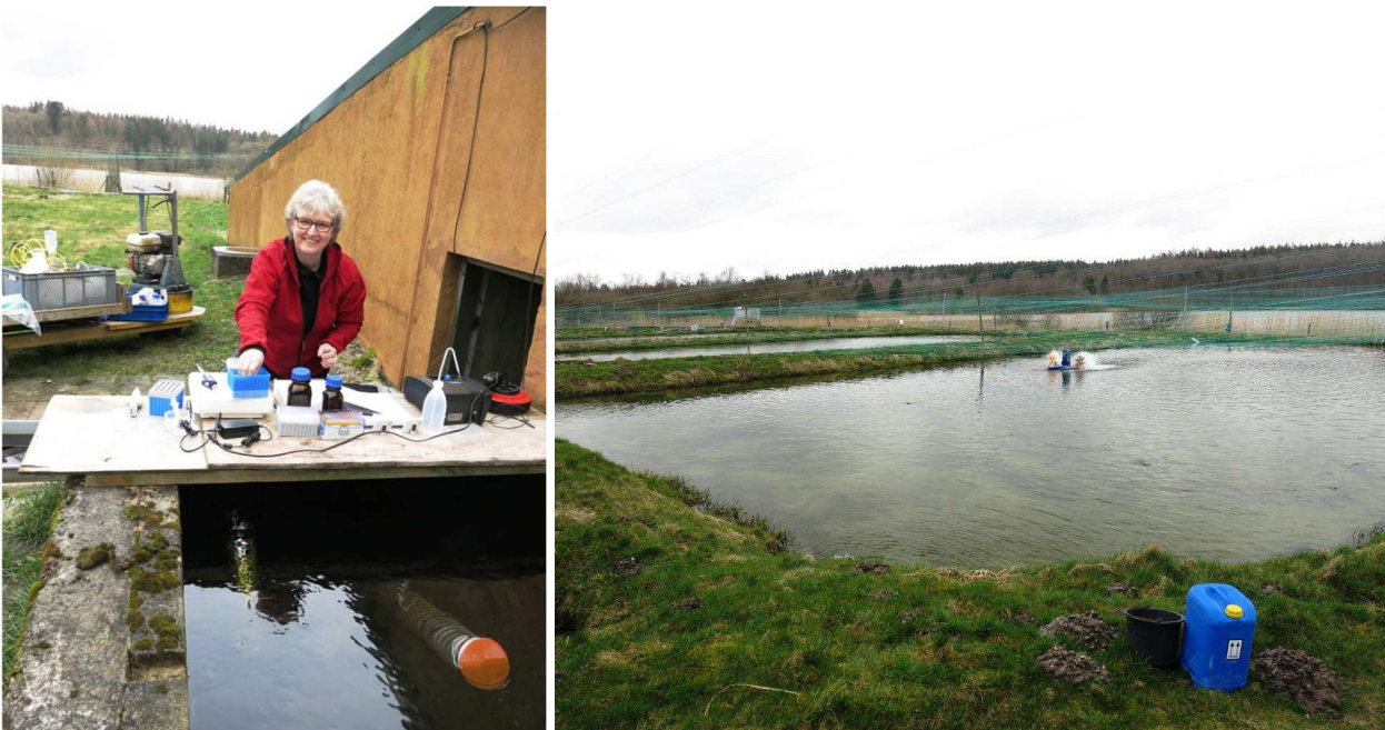
Figur 5.3.5. Måling på Halle Sø Dambrug. Pereddikesyre restmængden måles på stedet lige efter prøveudtagning da stoffet nedbrydes hurtigt. Oven for t.h. ses jorddam der blev behandlet med PerAqua Plus.
