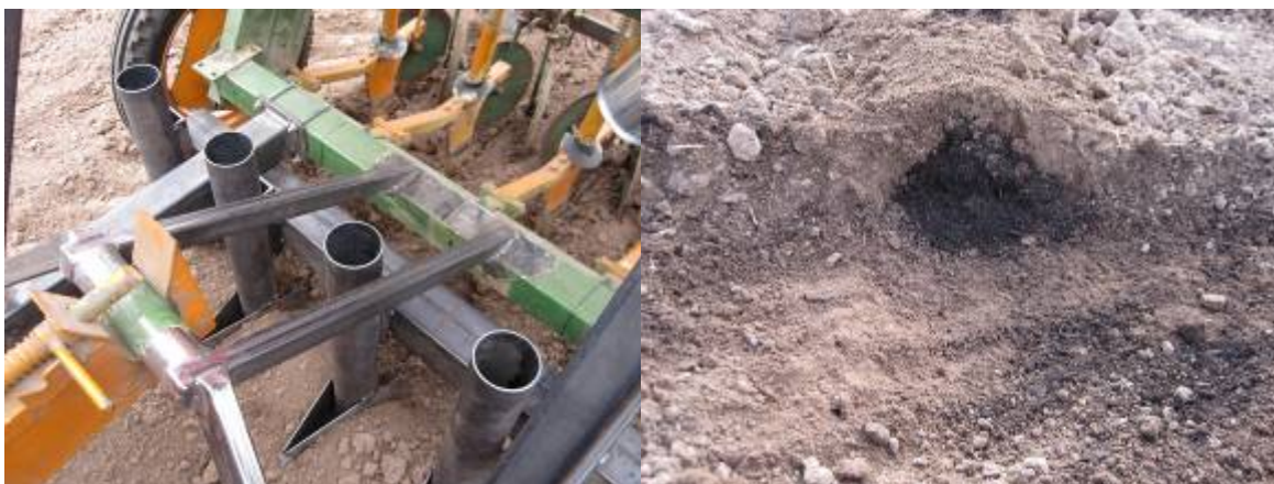
Abbildung 102: Draufsicht Furchenschare (Nr 2) und Lage des Kompostsubstrates im Boden
