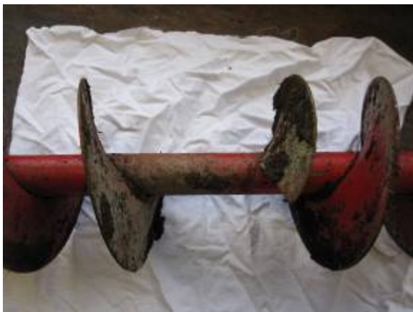
Abbildung 100: Dosierschnecken: links mit zusammen laufenden Gängen, rechts: mit frei auslaufenden Gängen
