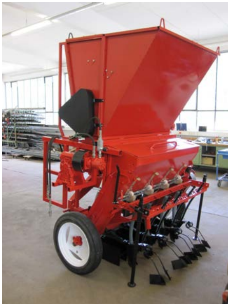
Abbildung 104: Endzustand Prototyp Kompost-Reihenapplikation und Drillmaschine
