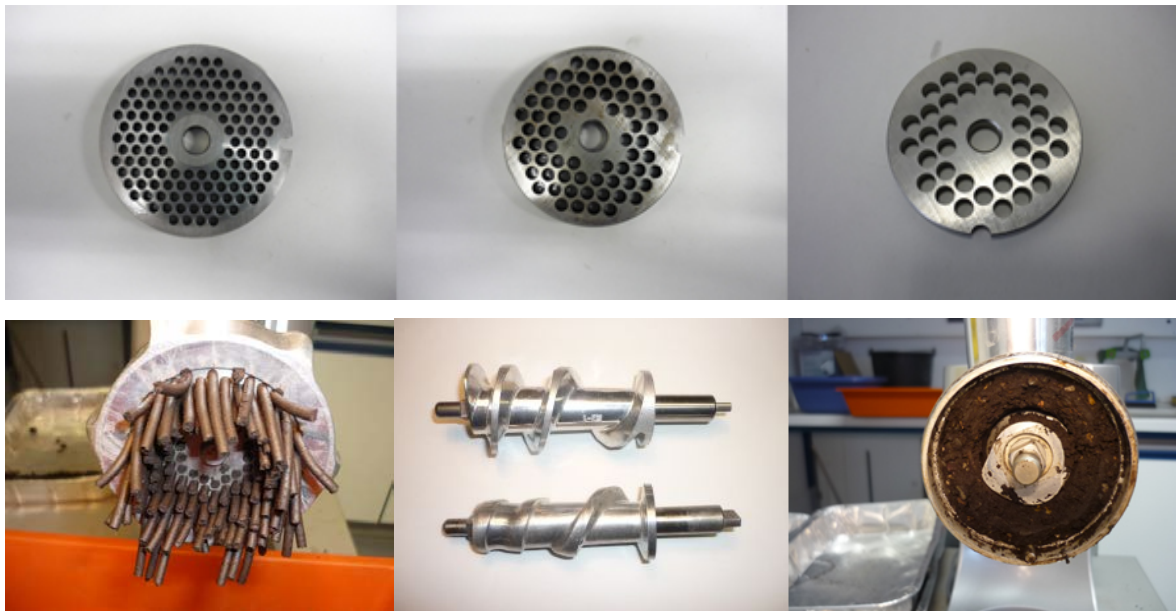
Abbildung 106: Matrizen mit unterschiedlichem Durchmesser und Ansicht eines Pressvorgangs im Extrusionsverfahren (unten links); Mitte und rechts: verschlissene Stahlschnecke nach mehreren Pressungen und Verstopfung der Scheckentunnels aufgrund unzureichender Förderleistung bei verschlissener Schneckenwelle
