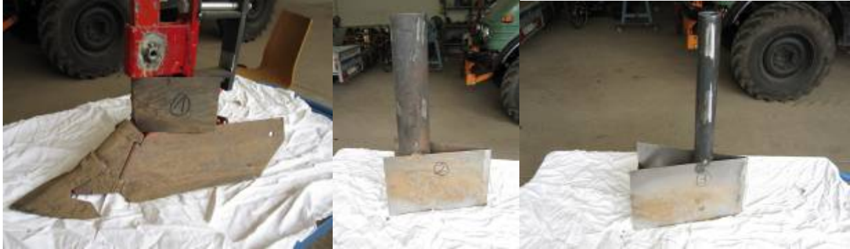
Abbildung 101: 3 realisiert Furchenschare Typ 1 , 2 und 3 (von links)
