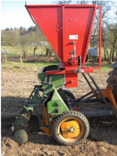
Abbildung 99: Kompostbunker montiert auf Drillmaschine
