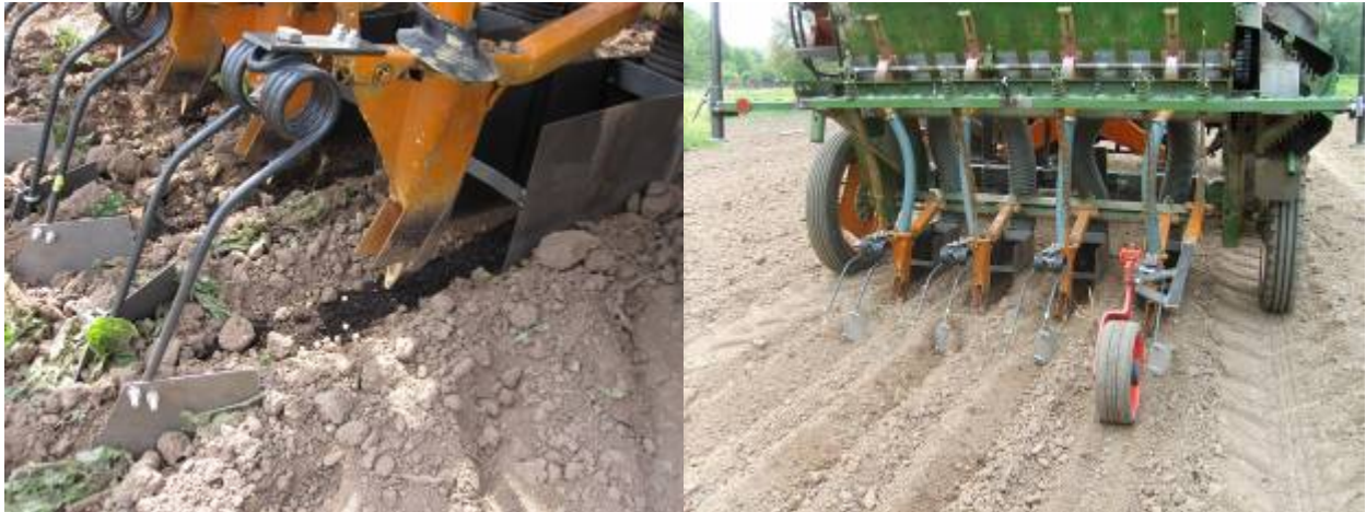
Abbildung 103: Zustreicher und Druckrolle von hinten gesehen
