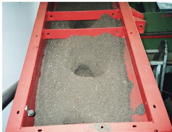
Abbildung 92: Austragsbild von Komposten (oben links) und Brückenbildungen bei Kompost, der direkt in einen Saatkasten (rechts) oder in einen Kastendüngerstreuer (links) gegeben wurde
