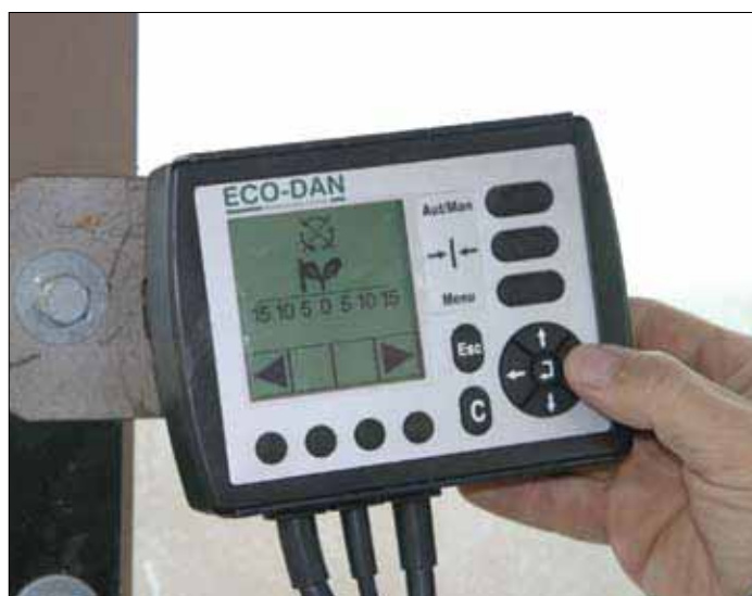
Display in der Traktorkabine für die Feineinstellung.
