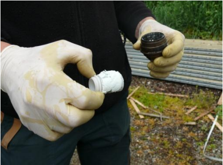
Abbildung 3 Verklebter Filter nach der Testspritzung im Gerät der Mittelprüfung
