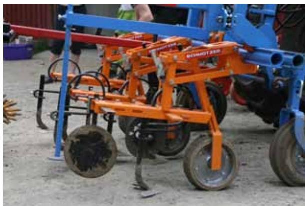
Gåseføtter og rulleskjær montert på parallellogram. Foto: Kari Bysveen.
