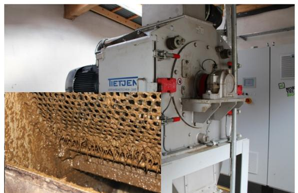
Abbildung 22: Beispiel für Aufschlussverfahren wie diese Kombination aus Hammermühle und speziellen Mikroorganismen können die Effizienz und Zuverlässigkeit vor allem mittlerer bis großer Anlagen verbessern. Foto: F. Gerlach, FiBL.
