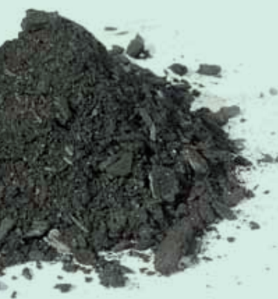
Biochar-Pyramide: Pyreg-Kohle aus der Maschine. Echantillon de biochar: Charbon Pyreg issu de la machine.
