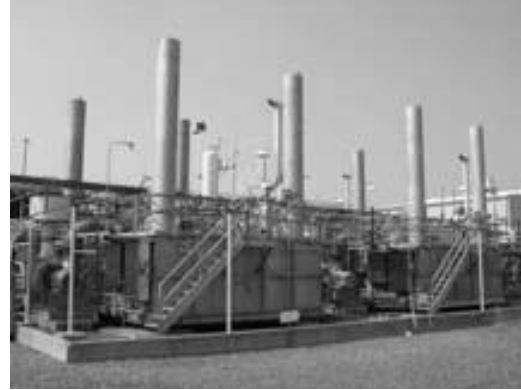
Figure 2.9 LNG submerged combustion vaporizer [6].
