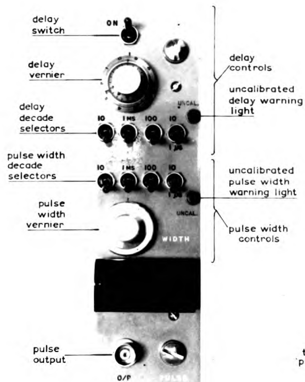
Fig. A.4. Pulse Generator Module:
