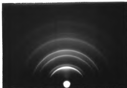
(d) Thickness = 350A at i = 0^\circ Pressure = 5 \times 10^{-5} torr Angle i = 0^\circ
