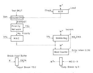
Fig. 2 Block Diagram DMA-Hardware
