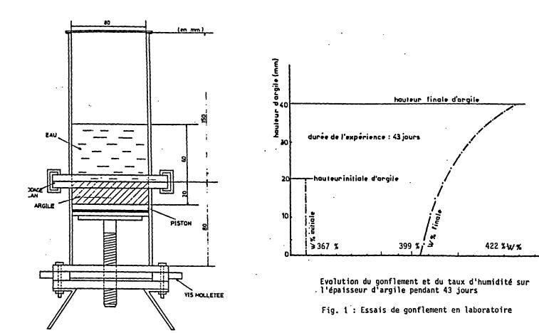
Dispositif expérimental pour l'étude de la distribution verticale de la teneur en eau dans l'argile
