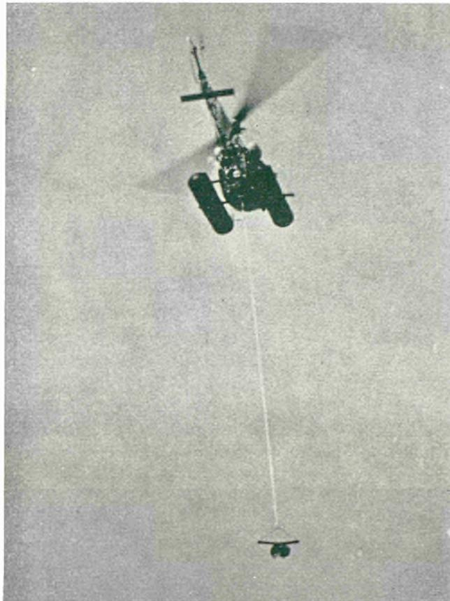
Bild 7 — Hubschrauber mit angehängten Backengreifer
