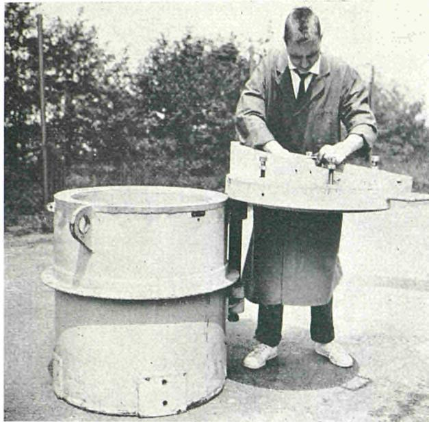
Bild 6 — Abschirmbehälter mit geöffneten Deckel
