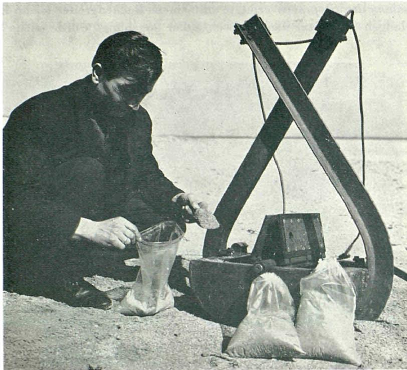
Bild 8 — Abfüllen des Greiferinhalts in Plastikbeutel
