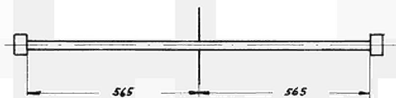
a) gerades Rohr  $25^{\phi} \times 2$  und  $22^{\phi} \times 1$
