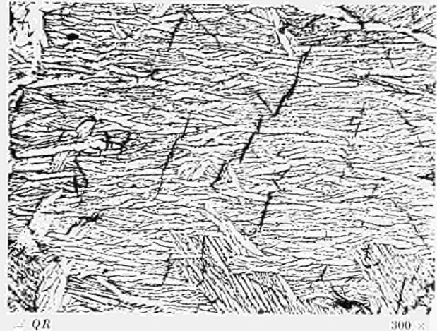
Abb. 24. ZrNb 2.5 \beta -geglüht (1000°C Ofenabkühlung) aus der Gasphase beladen (340 ppm H 2 )
