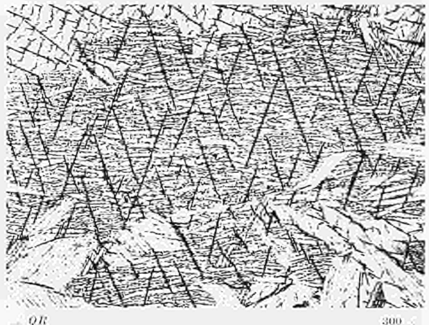
Abb. 25. ZrNb 2.5 \beta -geglüht (1000°C Ofenabkühlung), korrodiert, 500°C 1ata (250 ppm H 2 )
