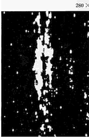
Differentialabrasterbild. Aluminiumreiche Zeilen mit einem Gehalt zwischen 95 und 100 Gew.-% Al erscheinen hell. (Al-K at , 5 KV)
