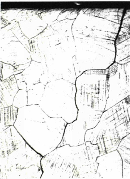
Fig. 16 — Curva in AISI 321 piegata a freddo che presenta incrinature ad andamento intercristallino dopo permanenza a temperature di esercizio superiori a 500 °C
