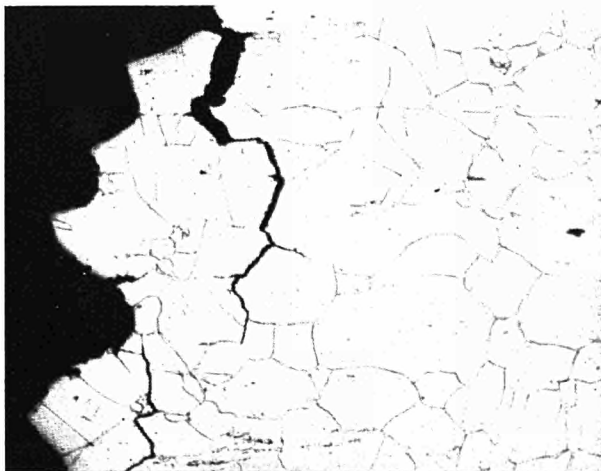
Fig. 14 — Frattura intercristallina in un acciaio inossidabile stabilizzato in seguito a precipitazione di carburo di niobio
