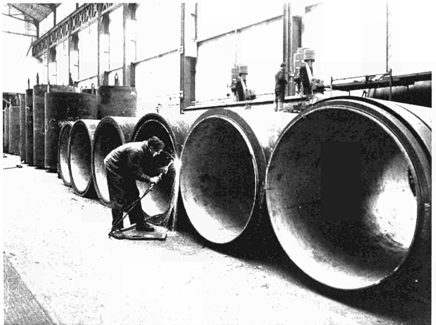
Fig. 2 — Viroles garnies d'une couche intérieure en acier austénitique type 316 L.
