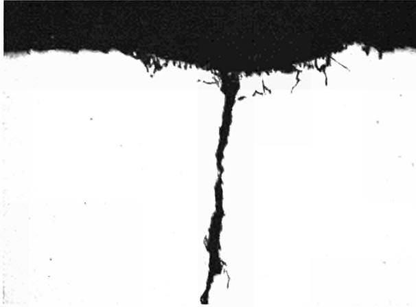
Fig. 29 — Cricca formatasi per corrosione sotto tensione che parte da un difetto superficiale della lamiera in acciaio inossidabile e si prolunga verso la saldatura
