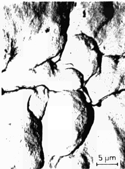
Abb. 5 Für einen Verformungsbruch im Mikrobereich typische Grübchen aus derselben Bruchfläche wie Abb. 3 (Elektronenmikro- fraktographie)
