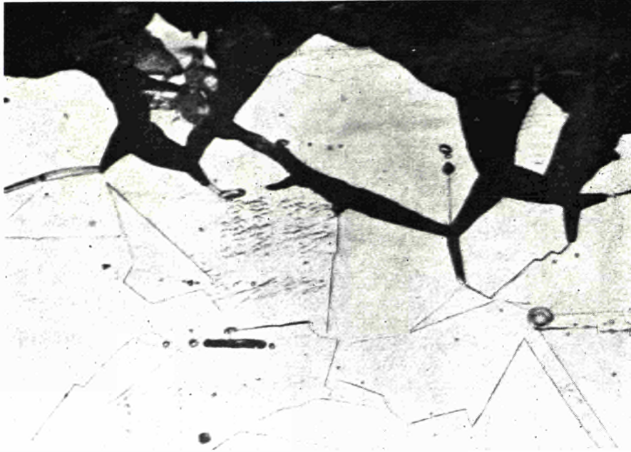
Abb. 1 — Trichterförmige interkristalline Angriffe bei einem Wärmeaustauscher aus Stahl des Typs 18 Cr 12 Ni 2,8 Mo in stark oxydierender Lösung
