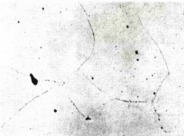
Fig. 10 — Acciaio inossidabile soggetto a corrosione intercristallina a causa della precipitazione di carburi al contorno dei grani di austenite per diffusione di carbonio dall'acciaio dolce del metallo base
