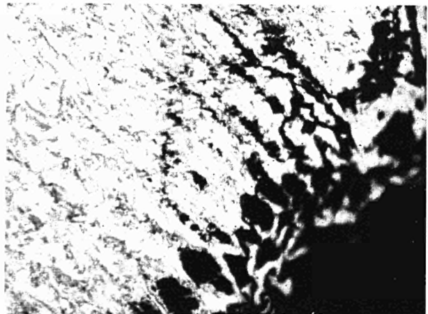
Fig. 9 — Particolare micrografico della saldatura di cui alla figura 8: corrosione di tipo interdendritico provocata dall'alterazione strutturale subita dal riporto inossidabile
