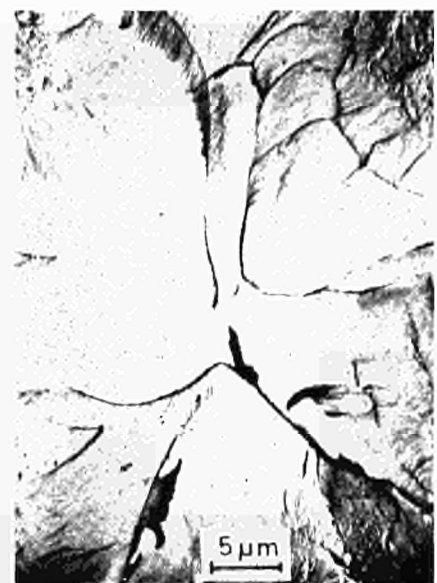
Abb. 4 Reißkämme als typisches Kennzeichen für einen Quasi-Sprödbuch im Mikrobereich. Elektronenmikrofraktographie aus derselben Bruchfläche wie Abb. 3
