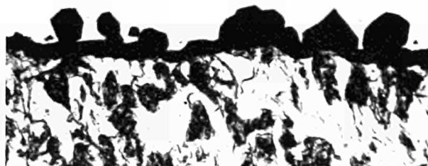
b) Oxydation en autoclave. Échantillon poli au papier 600. \times 1\ 200
