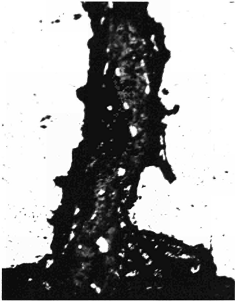
Fig. 25 — Particolare micrografico della figura 23 che mostra forte formazione di carburi e di fase \sigma nella zona della cricca
