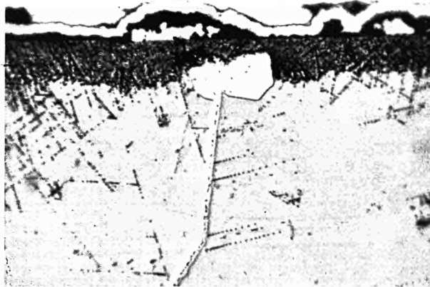
Fig. 5 — Inconel 600 après 1 200 heures dans la vapeur à 600 °C. Attaque électrolytique à l'acide oxalique. \times 1\,200
