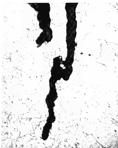
Fig. 38 — Particolare dell'estremità della cricca ripiena di prodotti della corrosione (Baker e Whitman)
