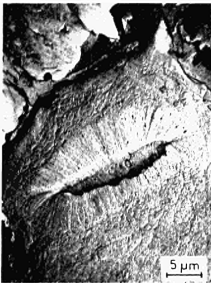
Abb. 7 — Schlackeneinschluß in der Dauerbruch-Anrißfläche eines Hohlzylinders aus dem Stahl 30 CrMoV 9 (Elektronenmikrofraktographie)
