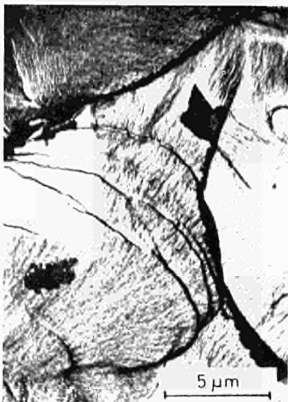
Abb. 3 — Elektronenmikrofraktographie eines geborstenen Hohlzylinders aus 30 CrMoV 9 mit den für einen Quasi-Sprödbuch im Mikrobereich typischen Stufen
