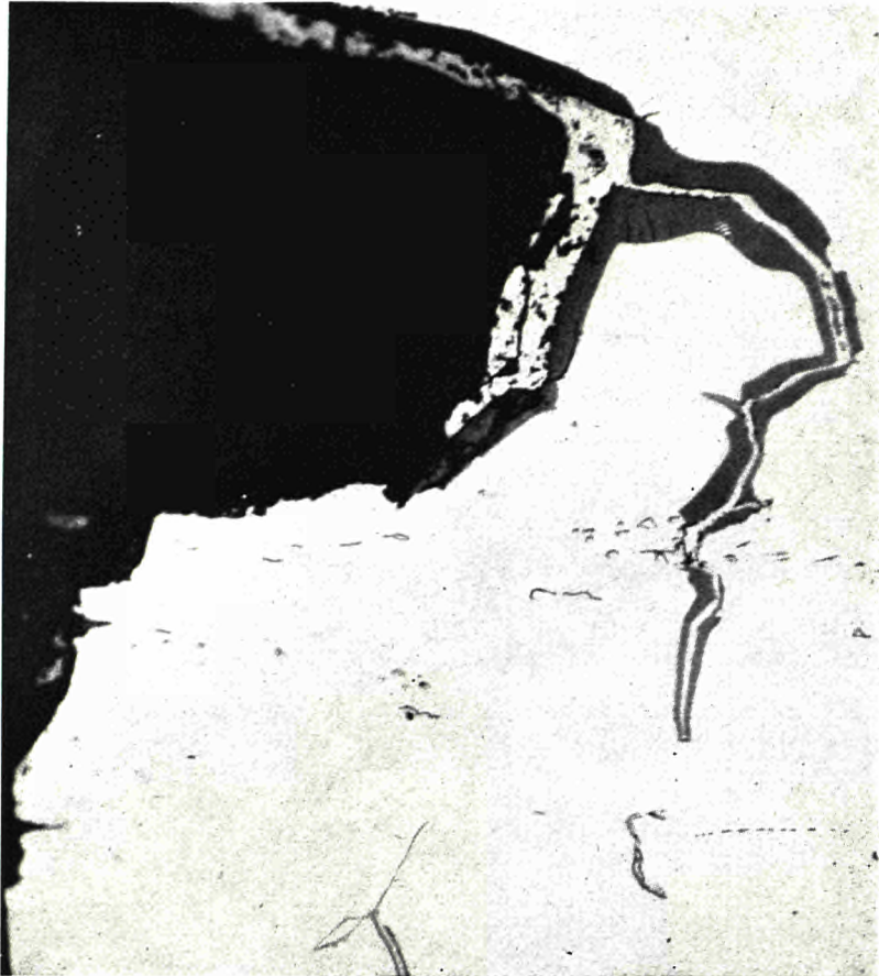
Fig. 15 — Frattura intergranulare in un acciaio AISI 347 saldato : ossidazione (zona grigio scuro) e ferro metallico (zona chiara) nell'interno della cricca
