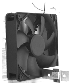
Abbildung 4-14: Axialventilator WALLAIR Modell 40967 . Eingebaut im oberen Bereich der Kollektortestvorrichtungen, um einen definierten und einstellbaren Volumenstrom der Luft durch den Kollektor zu ermöglichen.
