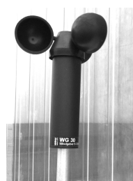
Abbildung 4-12: Schalenanemometer "WG 30" zur Messung der Windgeschwindigkeit.
