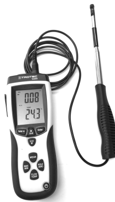
Abbildung 4-13: Hitzedrahtanemometer TA 300 der Fa. TROTEC.
