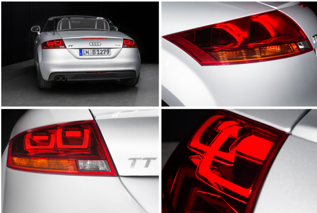
Abbildung 4.3.2: OLED-Demonstrator zum Projektabschluss des BMBF-Projekts „OLED-3D“ (Quelle: Audi).
