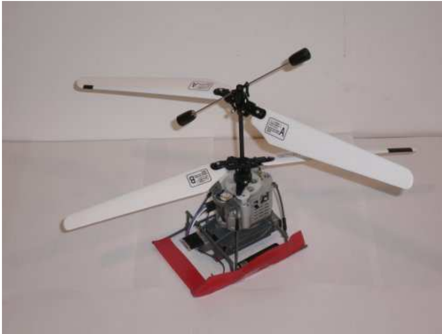
Abbildung 1.1: Koaxial-Hubschrauber UAV (15cm Rotordurchmesser) [DNH07]
