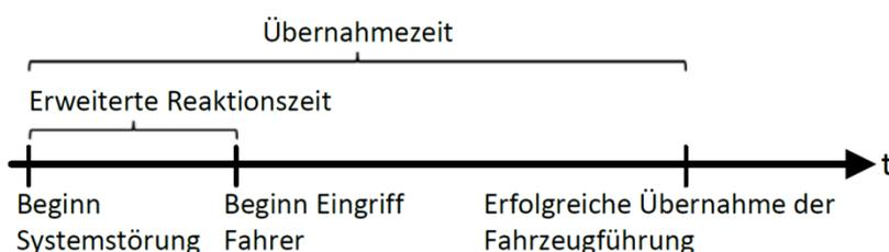
Abbildung 11: Ablauf einer erfolgreichen Übernahme der Fahrzeugführung durch den Fahrer im Falle einer Systemstörung
