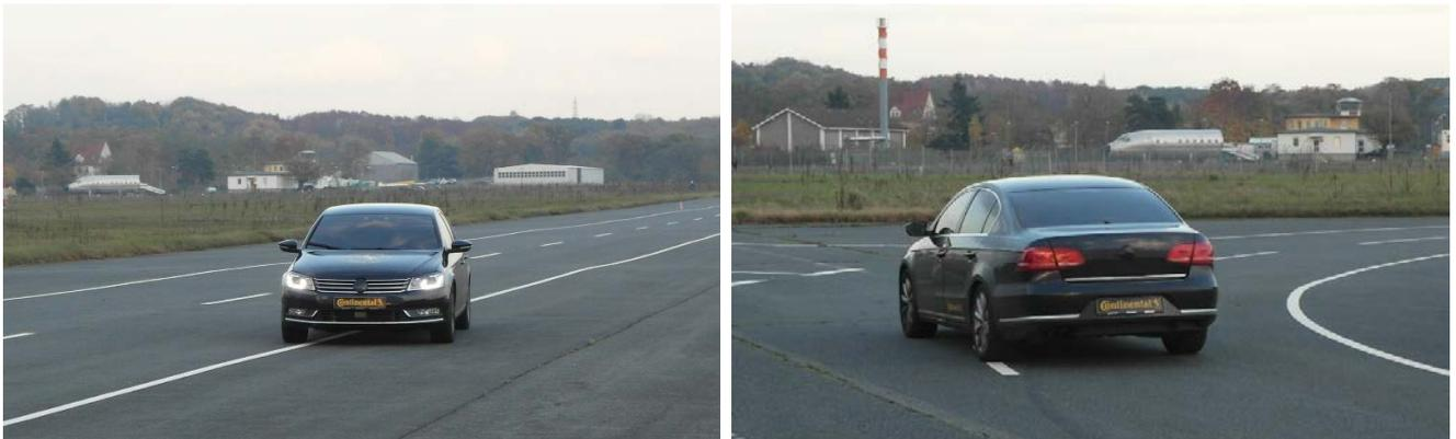
Abbildung 15: Systemstörung Querführung auf Gerade (QG)    Abbildung 16: Systemstörung Querführung in Kurve (QK)
