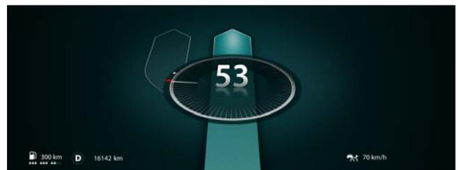
Abbildung 22: Anzeige im Modus „Kooperative Automation“: Aktives Manöver „Fahrstreifen folgen“ mit der Möglichkeit eines Fahrstreifenwechsels nach links (Pfromm et al., 2015)
