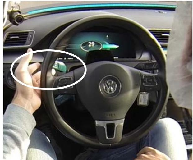
Abbildung 18: Manövereingabe per Fahrtrichtungsanzeiger-Hebel
