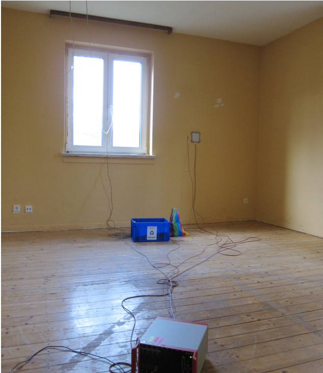
Abbildung 8.14: Innenraumaufnahme der U-Wert-Messung der Außenwand im unsanierten Fritz-Dächert-Weg 56-58. Die Abbildung zeigt die Wärmestromplatte und den innenraumseitig angebrachten Oberflächentemperaturfühler.
