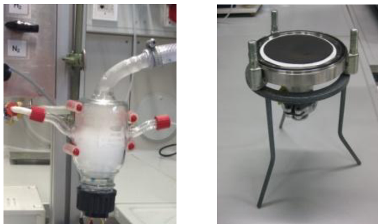
Abbildung 15: Links: Bildung von Nebel in der Nebelkammer. Rechts: Beheizte Filtereinheit zur Abscheidung des Produkts.
