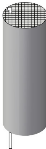
Abbildung 25: 3D-Illustration des Monolithen mit der Kapillare.
