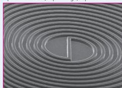
7,5 µm ma-P 1275 Spule, Windungen 10 µm
