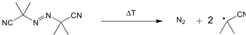
Abbildung 3.1: Bildung von Radikalen durch den Zerfall von AIBN [Tie-2005].
