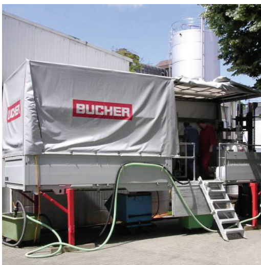
Abbildung A2-2: Fotos Versuchsanlage chem. Klärschlammkonditionierung
