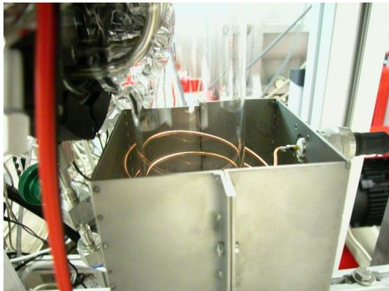
**Abbildung 11.4.:** Detailliertere Aufnahme der Plasmaspule.
