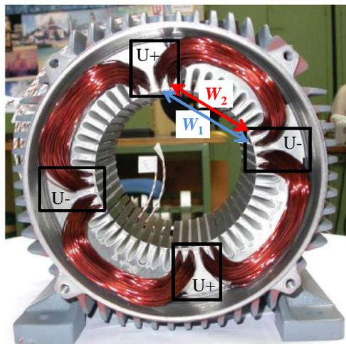
Abbildung 2.10: Geöffneter Stator einer 7,5-kW-Maschine, nach [Roc09a]
