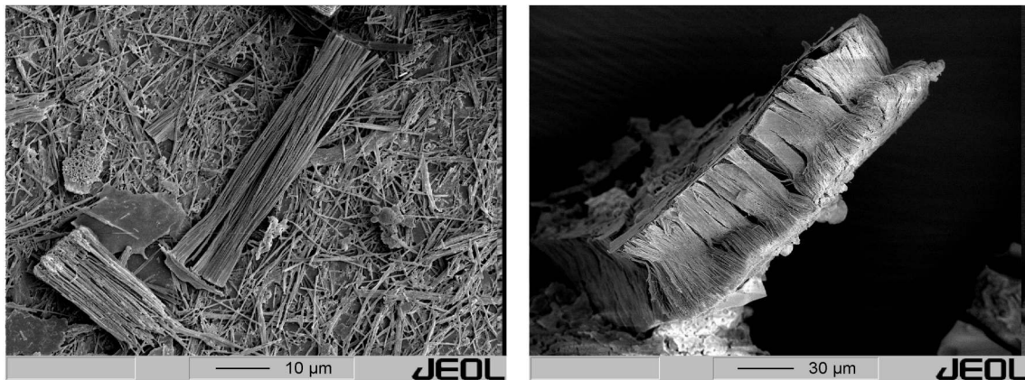
Abbildung 4–45: REM-Aufnahmen der Morphologie der freigesetzten keramischen Nanostrukturen (links) und nach der schrittweisen Entfernung der Aluminiumoxid-Membranen (rechts).
