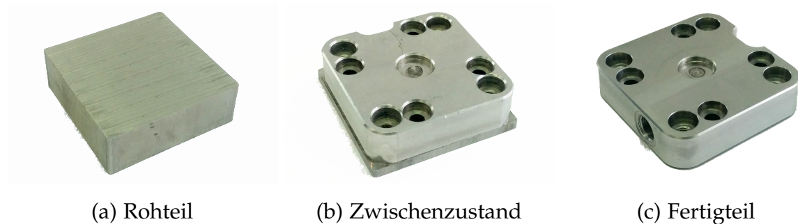
Abbildung A.1: Zwischenzustände eines Pneumatikzylinderbodens vom Typ D40
