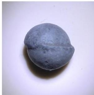
Abbildung 4.1 Exemplarische Katalysatorkugel aus versetzten Halbkugeln, hervorgerufen durch den Herstellungsprozess der Tablettierung.
