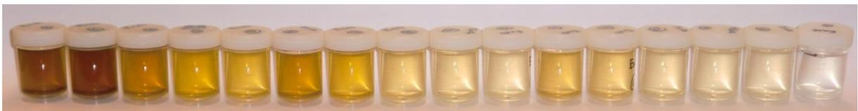
Abbildung 4.53 Foto der erhaltenen Lösungen aus den Waschungen des desaktivierten Katalysators, chronologisch von links nach rechts aufgereiht, ganz rechts: zum Vergleich eine Waschlösung des frischen Katalysators.
