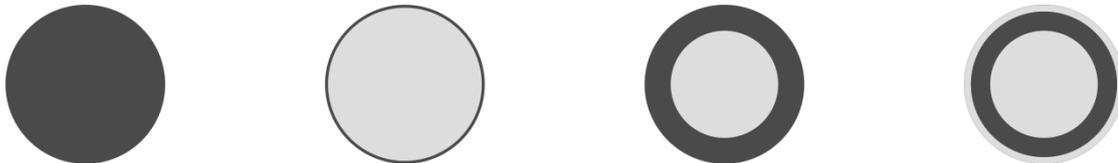
Abbildung 2.25 Schematische Darstellung verschiedener Schalenkatalysatortypen, von links: Vollkatalysator, Eggshell-Katalysator, Schalenkatalysator, Schalenkatalysator mit Inertschutzschale auf der Formkörperoberfläche.
