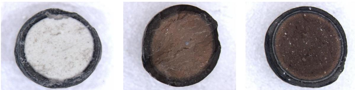
Abbildung 4.42 Querschnitt eines frischen Katalysators A (links) und zweier desaktivierter Katalysatoren A von Anfang (Kugel 1, mitte) und Ende des Reaktors (Kugel 40, rechts) nach einer Woche Desaktivierungsprotokoll unter Reaktionsbedingungen.
