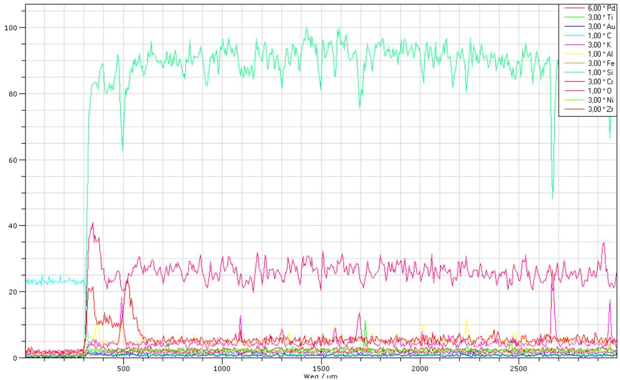
Abbildung V.17 Ergebnis eines Line-scans entlang des Durchmessers des Katalysatorquerschnitts, Beginn der Kugel bei etwa 300  $\mu\text{m}$ , hier gezeigt: Kat. A, frisch, nach Waschprozedur.
