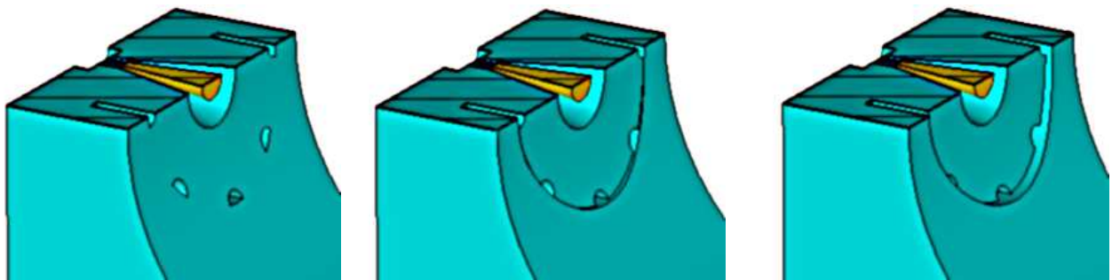
Abbildung 3.11: Im linken Bild aus dem Simulationsmodell schließt die Kante vom Pickupeinschub mit dem Strahlrohr ohne Übergang ab. Im mittleren Bild ist die Kante gezeigt, wenn der Pickupeinschub einen Rundungsradius von 20,25\ \text{mm} und das Strahlrohr ein Radius von 17\ \text{mm} besitzt. Im rechten Bild ist im Gegensatz zum mittleren Bild der Pickup um 0,5\ \text{mm} weiter nach außen versetzt, was durch ein Konstruktionsfehler an der Teststation hinter dem sFLASH der Fall ist.
