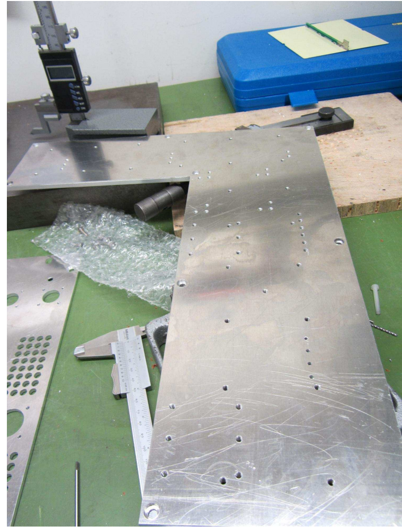
Abbildung A.14: Aluminiumbodenplatte der Thermobox. Diese wird mit Peltier-Elementen auf die gewünschte Temperatur stabilisiert. Zu sehen sind diverse Gewindelöcher für die Montage der Komponenten.
