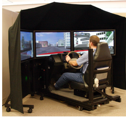
Abbildung 1.1: NADS MiniSim als Beispiel eines low-level Simulators ( www.nads-sc.uiowa.edu ).
