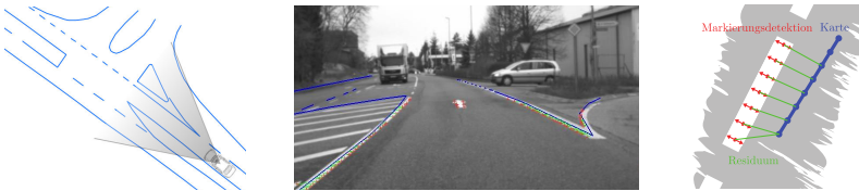
Abbildung 4: Markierungsbasierte Lokalisierung: Markierungskarte, Projektion ins Bild, Assoziation von Kartendaten und Messungen.
