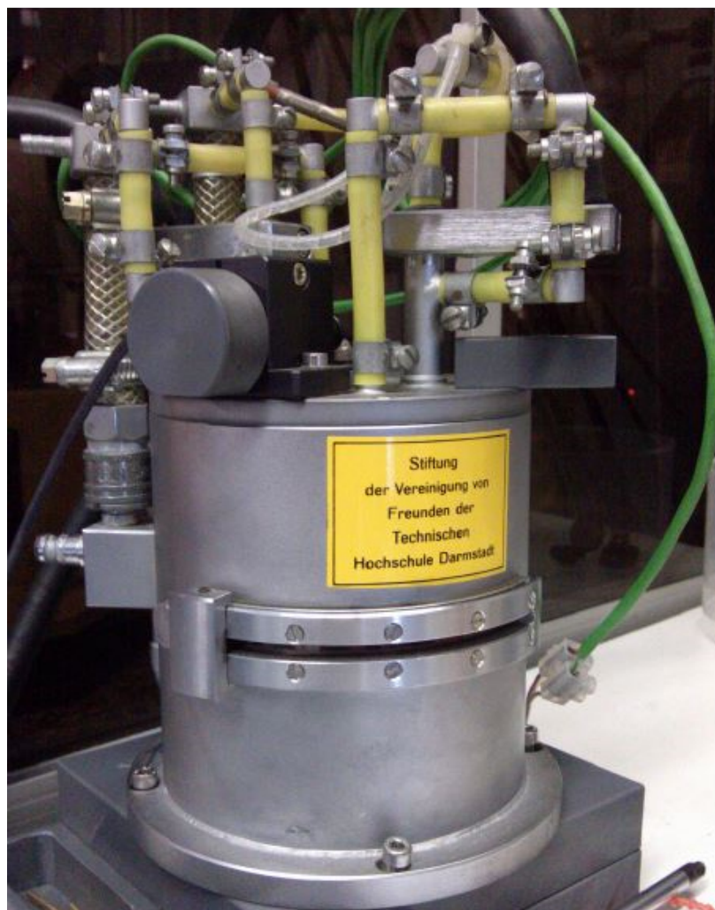
Abbildung 11: Wassergekühlter Ofen für das Pulverdiffraktometer STADI P (Fa. STOE & Cie GmbH, Darmstadt). Mittig der Haube ist der Austrittsschlitz für die die Röntgenstrahlung zu sehen.
