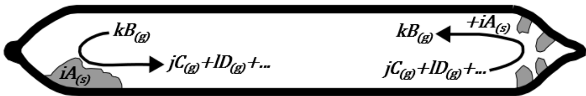
Abbildung 5: Schema zum chemischen Gasphasentransport im Temperaturgradienten ( T_2 > T_1 ).
