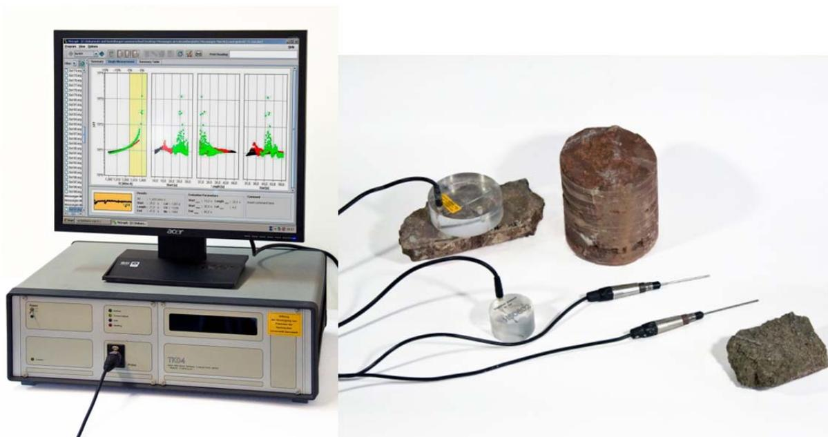
Abb. 6.13: TK04 Messgerät (links) mit unterschiedlichen Messsonden (rechts: Vollraumsonden und Halbraumsonden).
