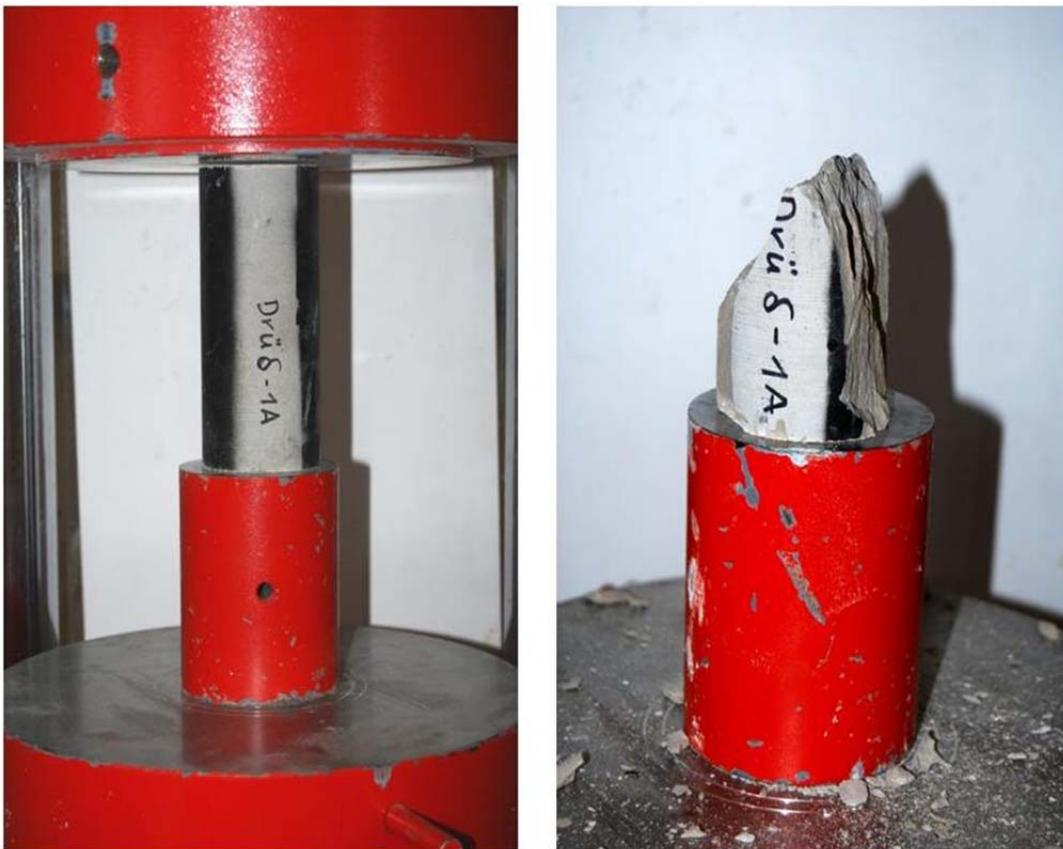
Abb. 6.28: Probenkörper *Drü 8-1A* ( $l = 145\text{mm}$ ,  $d = 64\text{mm}$ ) in der Prüfpresse vor (links) und nach dem Versuch (rechts). Deutlich sind im Versagenskörper die sich kreuzenden Bruchflächen zu erkennen.
