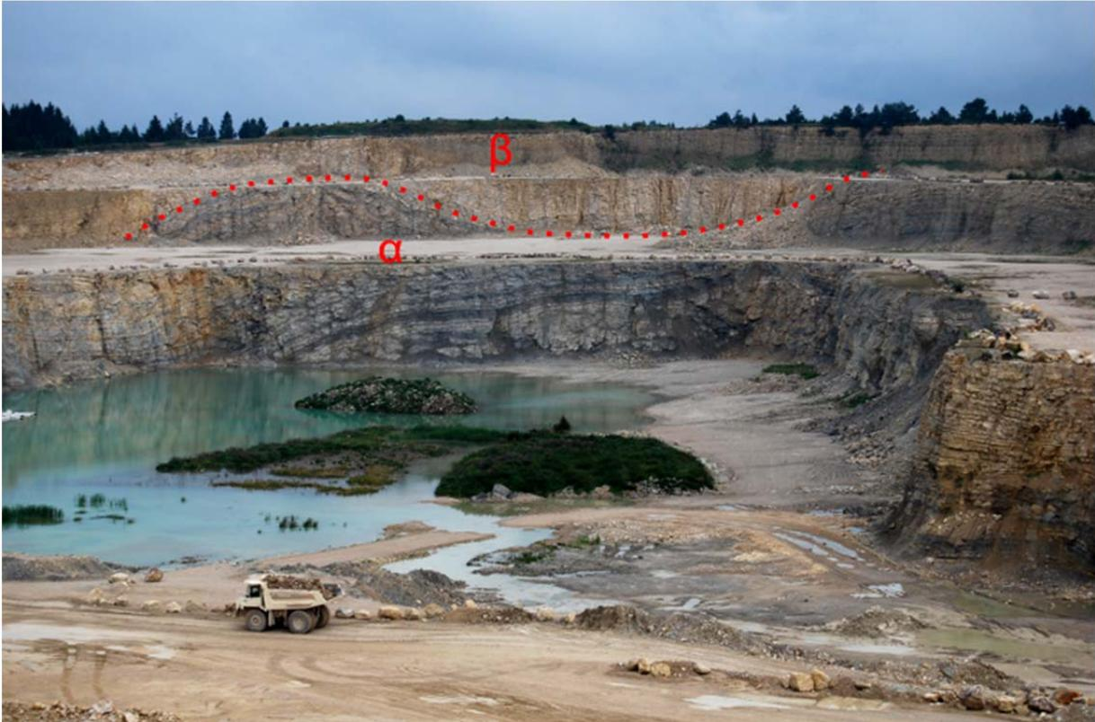
Abb. 7.12: Steinbruch Plettenberg, westliche Abbauwand. Lithostratigraphische Grenze zwischen Malm  $\alpha$  und Malm  $\beta$  (Welsch 2011).
