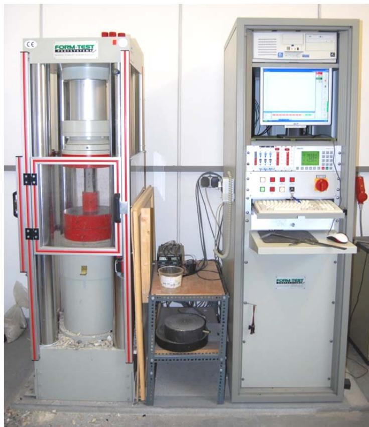
Abb. 6.27: Prüfpresse Typ 102/1000S für den einaxialen Druckfestigkeitsversuch.
