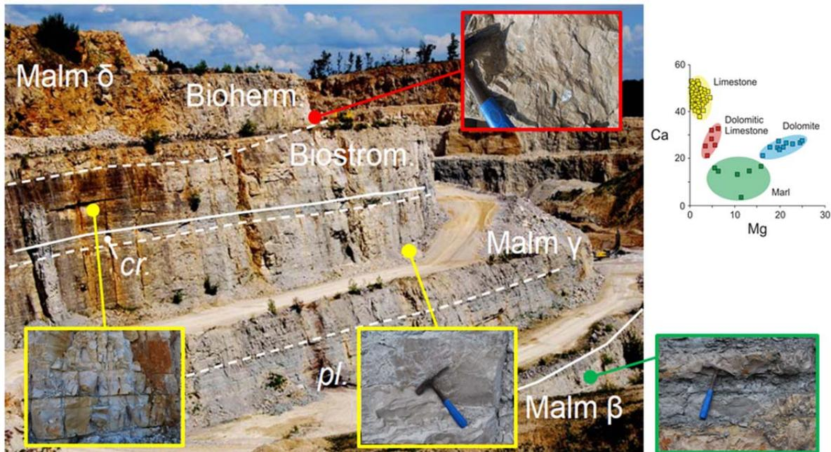
Abb. 6.6: Exemplarische Darstellung der stratigraphischen und lithologischen Kartierung eines Steinbruches: gelb umrandet: dickbankige, mikritische Kalksteine, grün umrandet: mergelige Kalksteine/Mergel, rot umrandet: dolomitisierte Kalksteine; cr.= *crussaliensis* Mergel, pl.= *platynota* Mergel (Homuth & Sass 2012).
