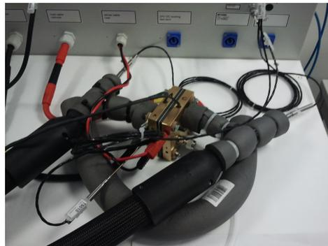
(b) Einzelzelle mit Anschlüssen.
