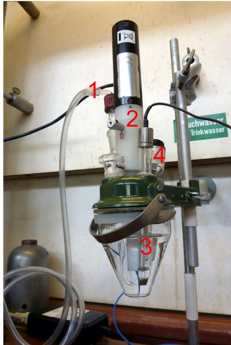
Abbildung 15.: Verwendeter Aufbau für Zyklovoltammetriemessungen und RDE Messungen. (1) Gaseinlass, (2) Arbeitselektrode mit Rotator, (3) Platin-Gegen-elektrode, (4) Referenzelektrode.
