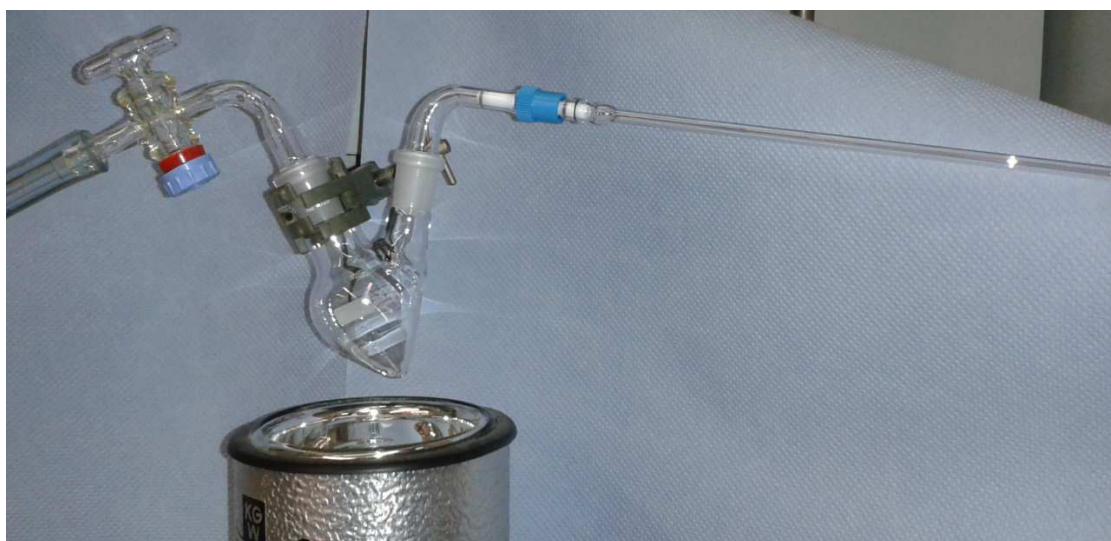
Abbildung 3-27: Apparatur zum Umkondensieren der flüchtigen Produkte 90a und 90c mit dem Lösungsmittel.
