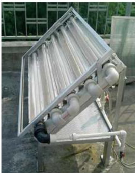
FIGURA 1.3. Reactor tipo CPC, compuesto de 5 reactores tubulares en serie, cada uno de ellos une dos reflectores parabólicos de aluminio anodizado.
