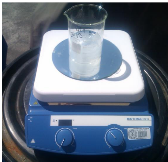
FIGURA 2.1. Reactor batch usado para experimentos de degradación solar.
