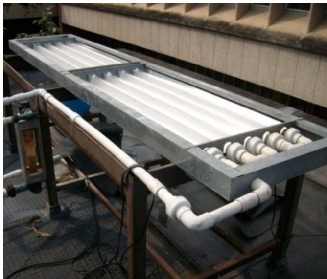
FIGURA 2.2. Reactor tipo CPC ubicado en la planta solar de la Universidad del Valle, donde se llevó a cabo la degradación de malatión.
