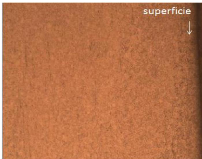
**Figura 48. Microestructura diámetro externo obtenida durante el proceso actual de escaneo con 95% de martensita.**
