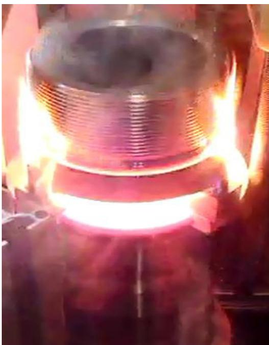
Figura 69. Calentamiento del diámetro externo después de 5 segundos.
