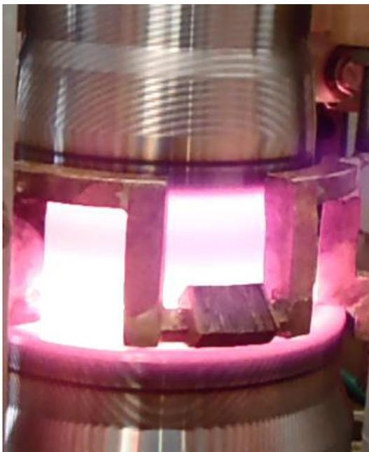
Figura 68. Calentamiento del diámetro interno después de 14 segundos.
