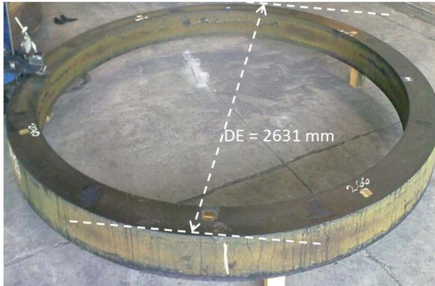
Figura34.- Dimensiones reales de la pieza denominada B2.
