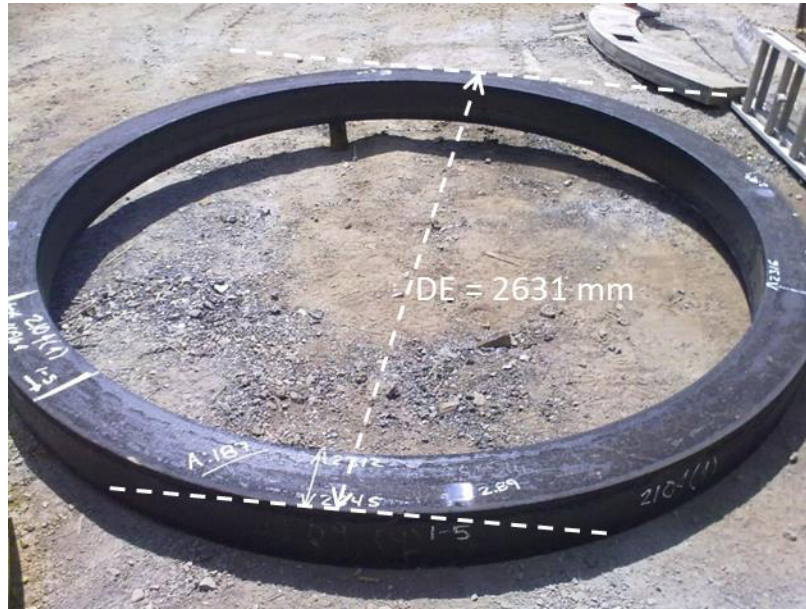
Figura32.- Dimensiones reales de la pieza denominada A1.
