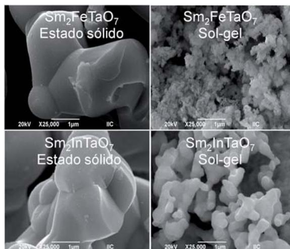
Fig. 5. Imágenes de MEB del  $\text{Sm}_2\text{FeTaO}_7$  y  $\text{Sm}_2\text{InTaO}_7$ .
