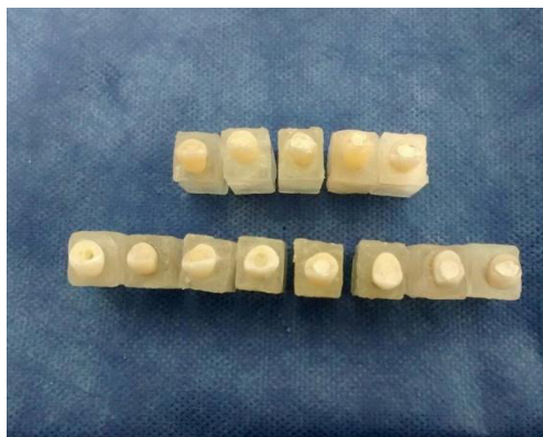
Figura 4. Los dientes de la muestra fueron colocados en cubos de acrílico de autocurado.
