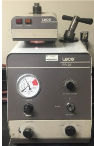
Figura 21. Encapsuladora Leco modelo PR-25.
