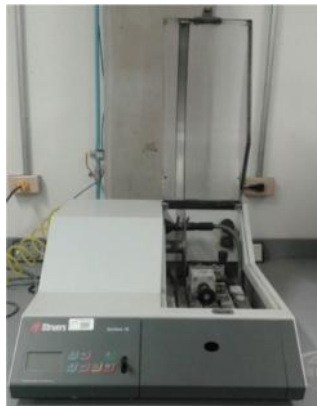
Figura 15. Cortadora Struers modelo Secotom-10.
