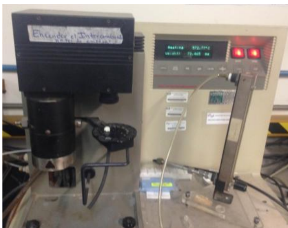
Figura 18. Equipo de Termogravimetría TA Instruments modelo TGA 2950.
