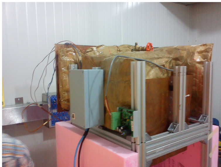
Figura 4.38: Sistema de refrigeración auto contenido en el prototipo.
