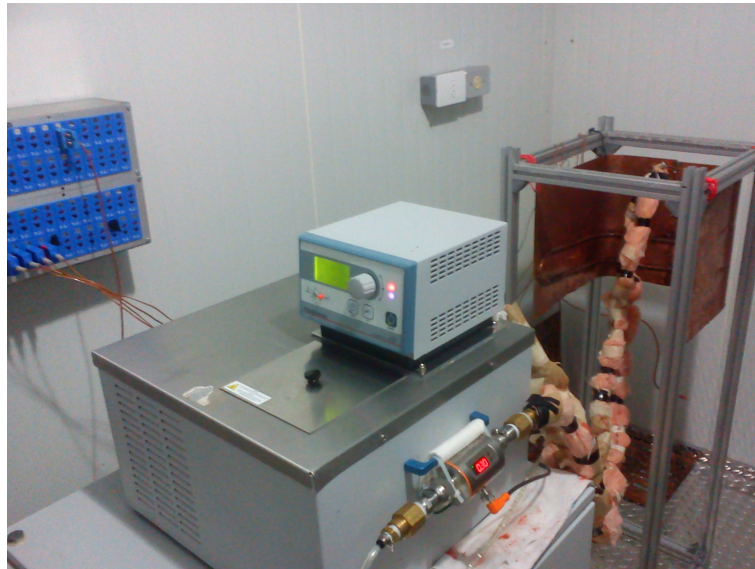
Figura 4.19: Instalación experimental utilizada en la caracterización de los intercambiadores de calor.
