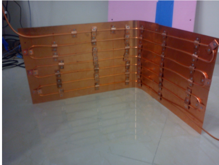
Figura 4.16: Condensador fabricado en cobre.
