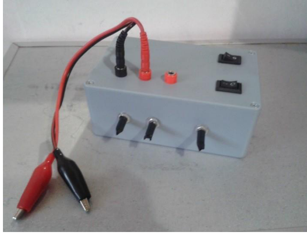
Figura 4 . Electro estimulador. Dispositivo capaz de generar una corriente de 20\mu\text{A} .
