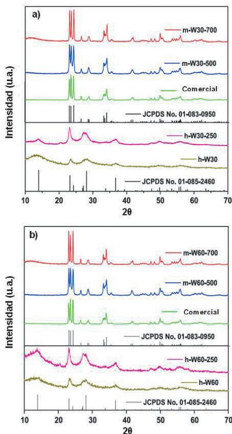
Fig. 1. Diagrama de difracción de rayos-X en polvo de WO<sub>3</sub> sintetizado por el método de microondas asistido por hidrotérmal: a) 30 minutos y b) 60 minutos a diferentes tratamientos térmicos 250, 500 y 700°C.
