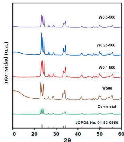
Fig. 2. Diagrama de difracción de rayos-X en polvo de WO<sub>3</sub> sintetizado por el método de ultrasonido con y sin CTAB.
