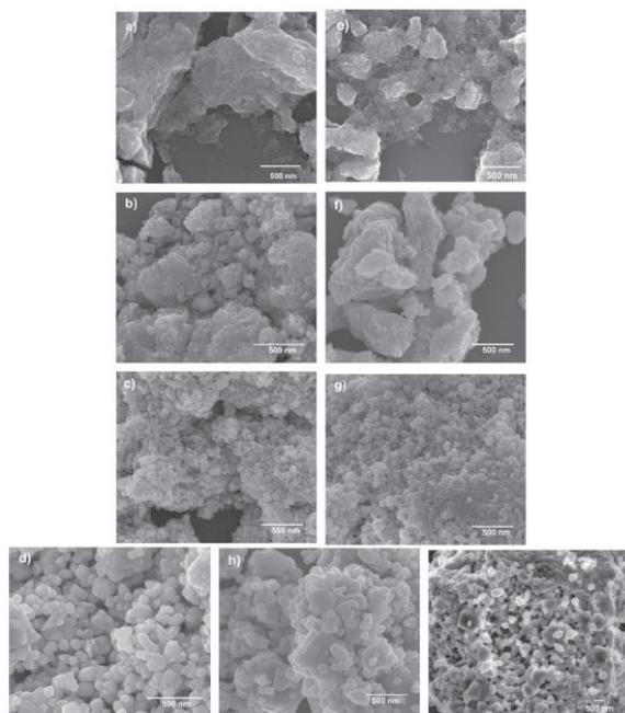
Fig. 3. Análisis de la morfología por SEM de las partículas de  $\text{WO}_3$  sintetizadas por microondas asistido por hidrotermal a 30 minutos *a)* sin tratamiento térmico, con tratamiento térmico: *b)* 250°C, *c)* 500°C y *d)* 700°C y con 60 minutos *e)* sin tratamiento térmico, con tratamiento térmico: *f)* 250°C, *g)* 500°C y *h)* 700°C; imagen *i)* muestra comercial.
