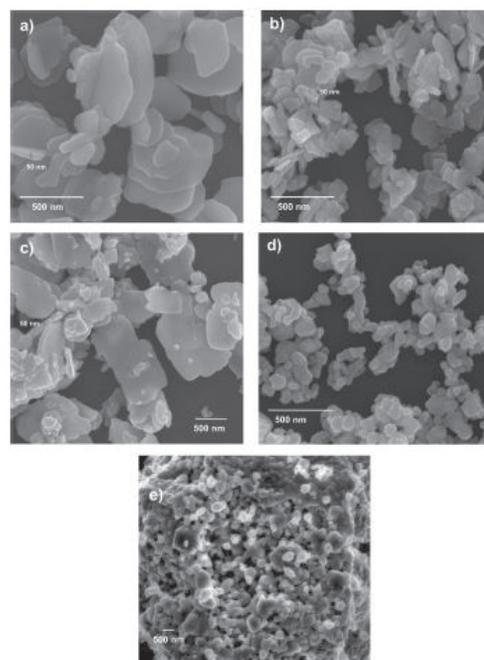
Fig. 4. Análisis por MEB de la morfología de  $\text{WO}_3$  obtenido por el método de ultrasonido asistido con y sin CTAB: *a)* W500, *b)* W0.1-500, *c)* W0.25-500, *d)* W0.5-500 y *e)* comercial  $\text{WO}_3$ .
