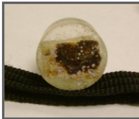
Figura 8. Muestra preparada petrográficamente.
