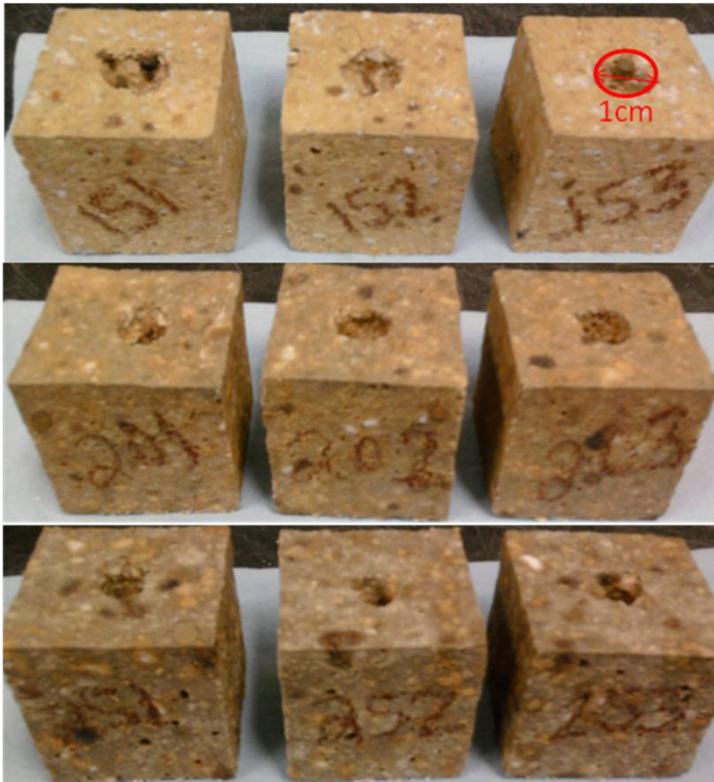
Figura 9. Fotografía de las muestras perforadas para llevar a cabo el ataque corrosivo con escoria de horno de arco eléctrico.
