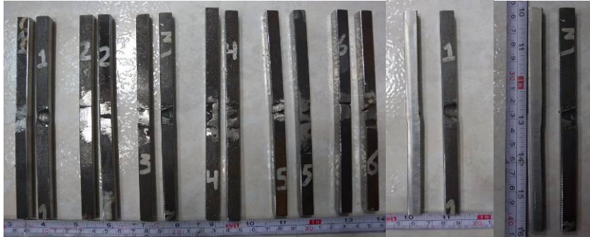
Figura 4.6. a) Totalidad de probetas, b) Medida lateral y ancho, c) Medida longitudinal.
