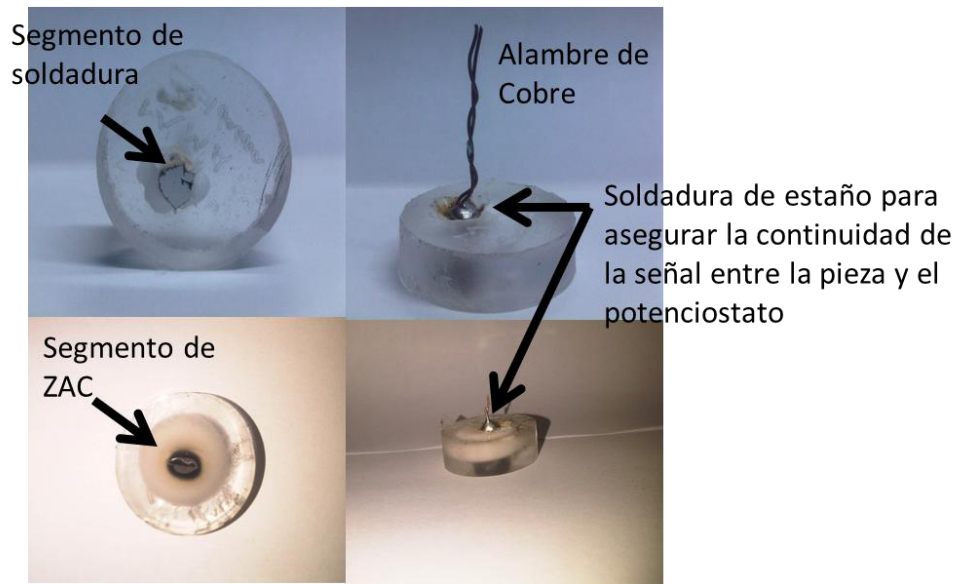
Figura 4.17. Montaje del electrodo de trabajo.
