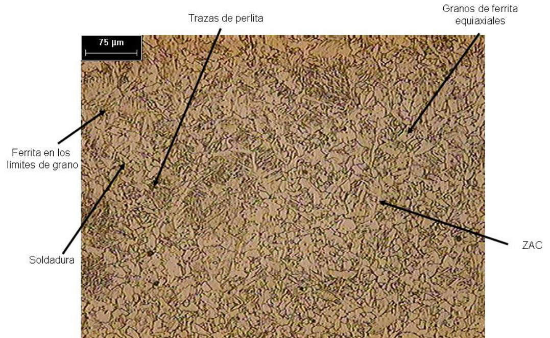
Figura 5.11. Imagen que muestra las diferentes fases presentes en el área de soldadura y ZAC.
