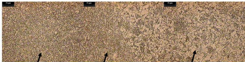
Metal base Área de la ZAC Área de la soldadura
